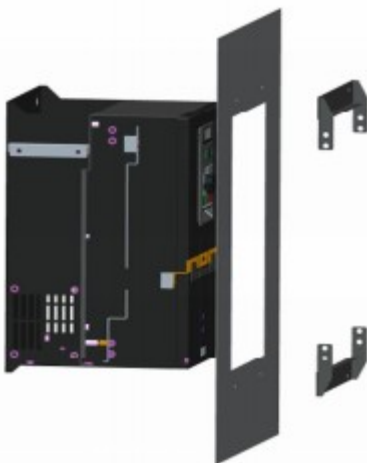
图3-4.CT500/CT500S变频器钣金结构穿墙式安装图
